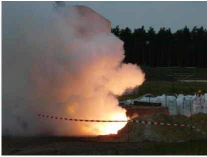
Bild C: 245 kg burning magnesium (BAM, Sperenberg, Germany)
