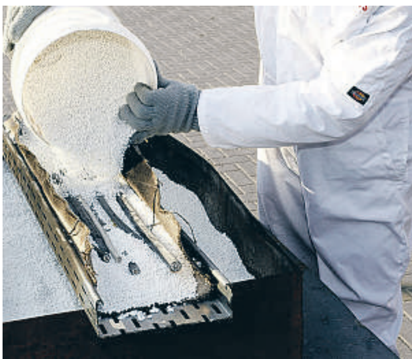
Vorbereitung für den Test: Kabel werden in einer Kabelprüfritze mit Pyrobubbles überschüttet. Die weißen Granulate sollen das Feuer abhalten.
