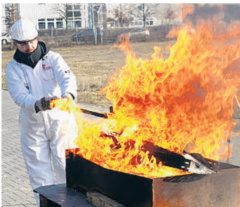
Dann gießt Mathias Treisch brennendes Benzin über die Leitungen. Die Flammen schlagen hoch, doch die Kabel bleiben unversehrt.
