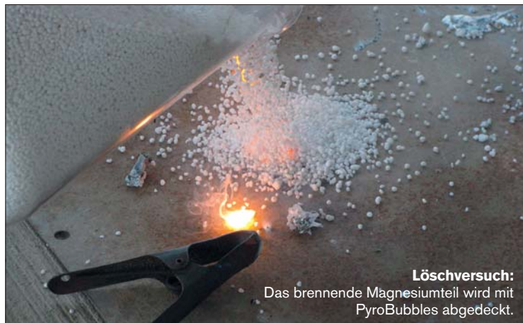
Kompakt: Die kleinen PyroBubbles bilden eine geschlossene Oberfläche, so dass keine Kapillarwirkung entsteht.
