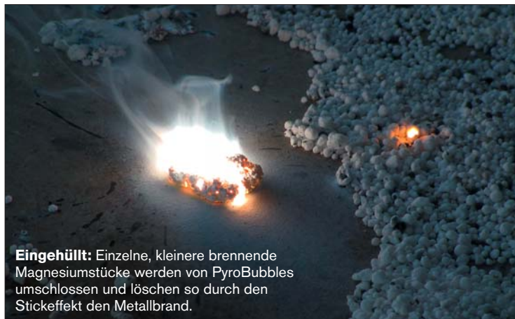
Metallbrand: Ein Magnesiumteil wird zum Entzünden gebracht. Dabei entstehen sehr hohe Temperaturen.
