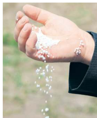
So sehen die Pyro-Bubbles aus. Sie löschen und dämmen.
