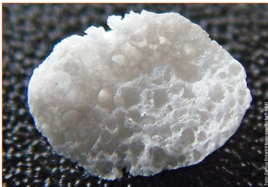
Abb. 1: Querschnitt eines Hohlglasgranulates
