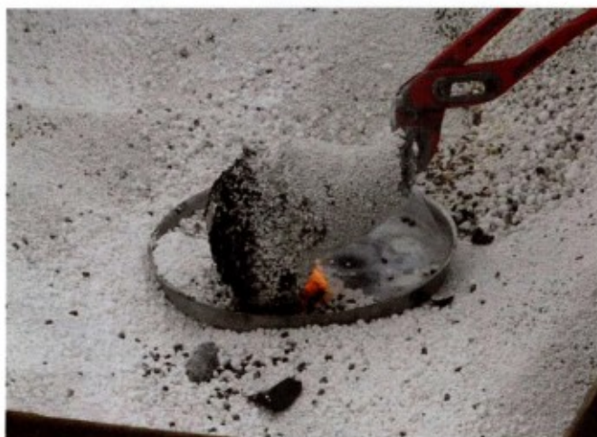
Bild 1 Löschen von Metallbränden (Magnesiumbrand, hier das eingeschlossene „abgebrannte“ Metallstück).
